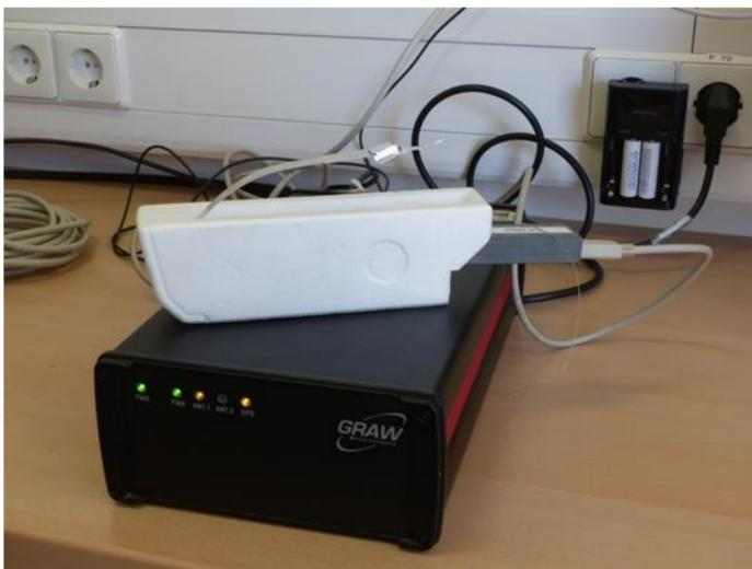
Abb. 1 Radiosonde und Bodenstation
